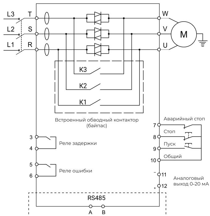
\*Напряжение управляющей цепи клемм 7, 8, 9, 10 + 12 VDC
