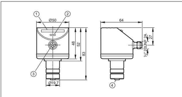
1: Светодиодный дисплей, 2: Кнопка настройки, 3: подключение напряжения питания и выходных сигналов, 4: подключение для датчиков потока
