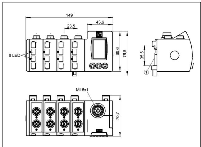
1: Установка на DIN-рейке
