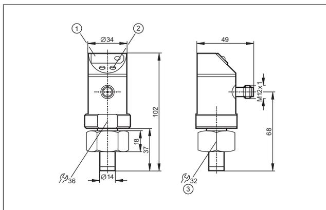
1: 7-сегментный светодиодный дисплей, 2: Кнопки для программирования, 3: Внутренняя резьба M26 x 1,5
