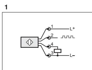
2: Импульсный выход (последовательность импульсов соответствует частоте демпфирования), 4: коммутационный выход (регулируемый)
