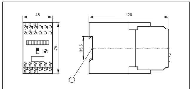
1: Установка на DIN-рейке
