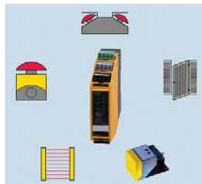
К реле безопасности можно подключить как электронные, так и механические датчики безопасности.
