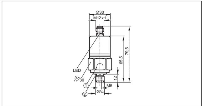
1: Механизм разгрузки давления, Не прибегайте к механической силе на механизм разгрузки давления., 2: Уплотнение FPM / DIN 3869-14
