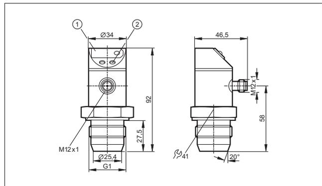
1: 7-сегментный светодиодный дисплей, 2: Кнопка для программирования
