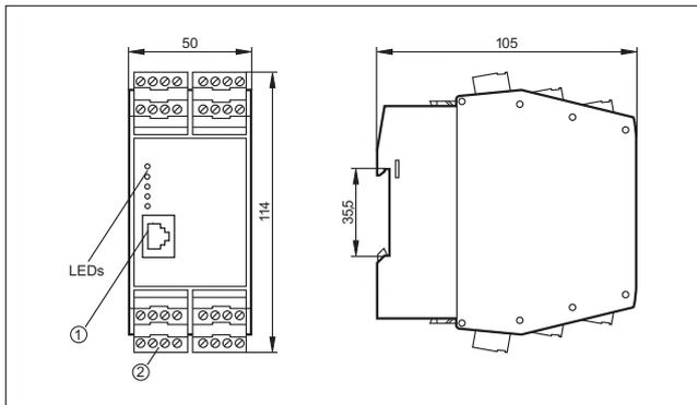
1: Ethernet интерфейс, 2: Разъем CombiCon с винтовыми клеммами
