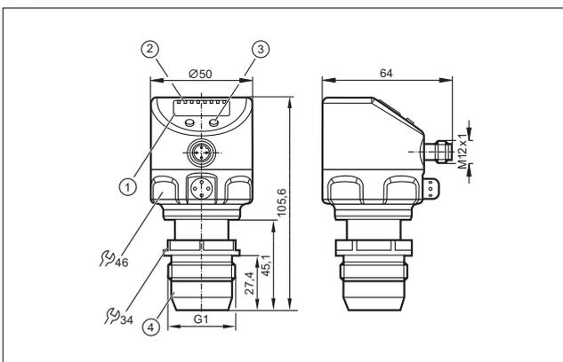
1: 4-х позиционный буквенно -цифровой дисплей, 2: Светодиоды состояния, 3: Кнопка для программирования, 4: Уплотнительный конус G 1 A, Внимание: Прибор должен устанавливаться только в рабочее соединение для уплотнительного конуса G1! Уплотнительный конус G1A подходит только для адаптеров с металлическим концевым ограничителем!
