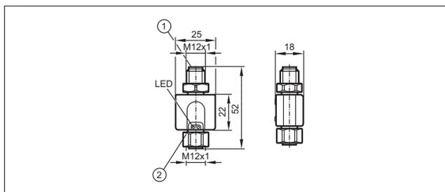
1: подключение напряжения питания и выходных сигналов, 2: соединение для подключения датчика температуры
