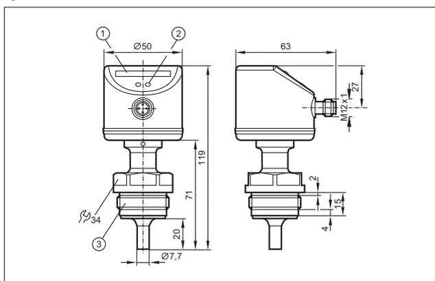
1: Светодиодный дисплей, 2: Кнопка настройки, 3: Резьба G1/Aseptoflex Vario
