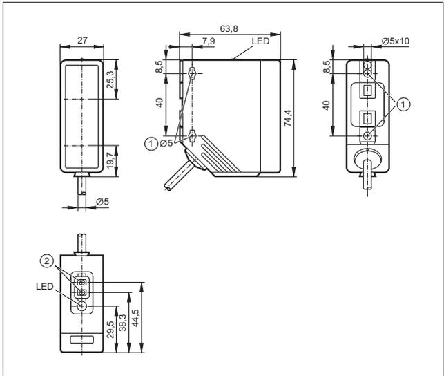
1: Максимальный момент затяжки для крепежного винта М5 - 2 Нм, 2: Кнопки для программирования
