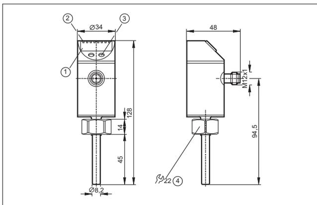
1: 4-х позиционный буквенно-цифровой дисплей, 2: Светодиоды состояния, 3: Кнопка для программирования, 4: внутренняя резьба M18 x 1,5
