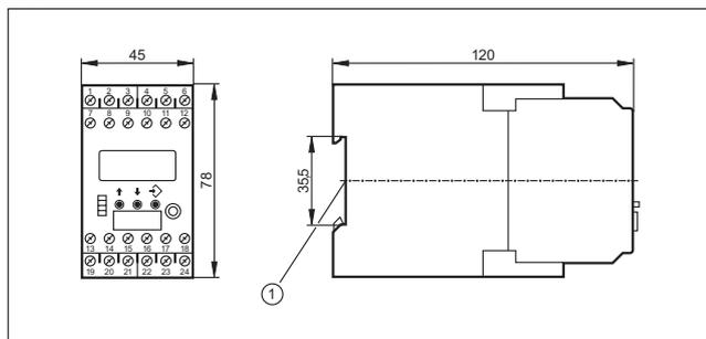
1: Установка на DIN-рейке
