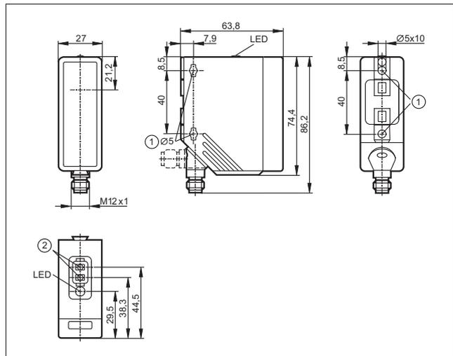
1: Максимальный момент затяжки для крепежного винта М5 - 2 Нм, 2: Кнопки для программирования
