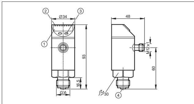
1: 4-х позиционный буквенно-цифровой дисплей, 2: Светодиоды состояния, 3: Кнопка для программирования, 4: соединение для подключения датчика температуры
