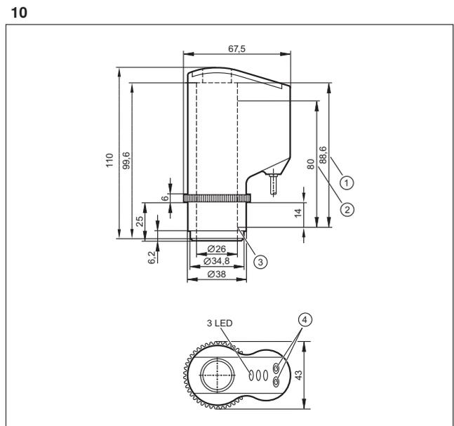
1: Максимальный ход шпинделя, 2: Расстояние измерения, 3: Исходное значение диапазона измерения (нулевая точка), 4: Кнопки для программирования
