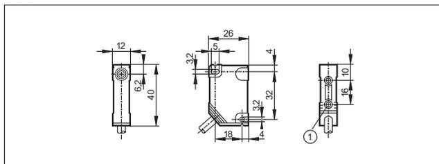
1: Соединительная втулка, резьба М3, глубина 5,8 мм, макс. момент затяжки 1,2 Нм (крепежный винт тип 8.8), если латунная втулка в контакте с ответной частью
