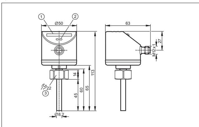
1: Светодиодный дисплей, 2: Кнопка настройки, 3: момент затяжки 25 Нм
