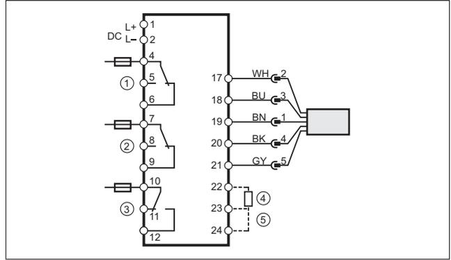
1: Контроль потока, 2: Контроль обрыва провода, 3: Контроль температуры, 4: Время задержки включения питания, 5: Выбор среды: жидкость / газ, Примечание: миниатюрный предохранитель по стандарту IEC60127-2 лист 1,, ≤ 5 A (быстродействующий)
