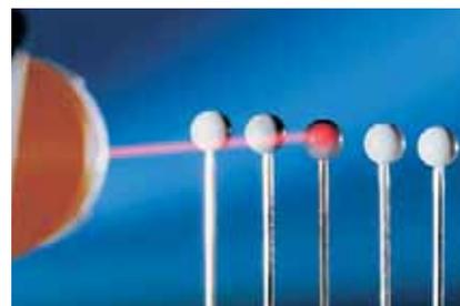
Когерентность: лазерные датчики излучают свет определенной длины волны и одинакового фазового положения.
