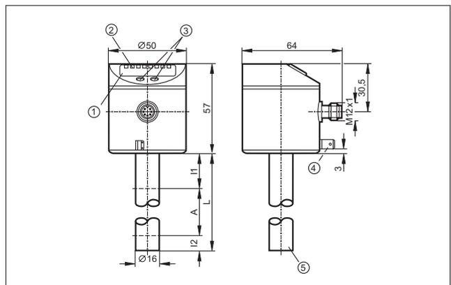
1: 4-х позиционный буквенно -цифровой дисплей, 2: Светодиоды состояния, 3: Кнопки для программирования, 4: Подключение корпуса (разъем с плоскими клеммами 6.3 мм согласно DIN 46244), 5: Положение температурного измерительного элемента
