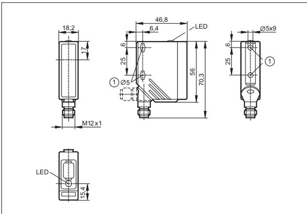
1: Максимальный момент затяжки для крепежного винта M5 - 2 Нм
