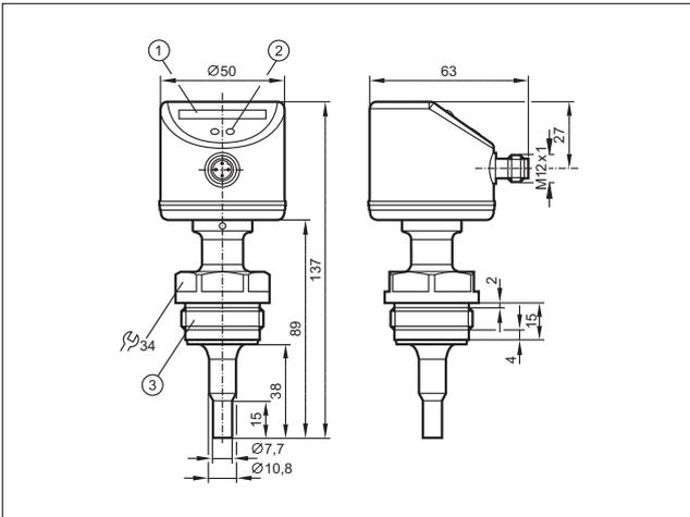
1: Светодиодный дисплей, 2: Кнопка настройки, 3: Резьба G1/Aseptoflex Vario
