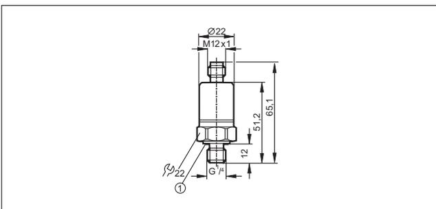
1: Уплотнение FPM / DIN 3869-14, момент затяжки 25 Нм
