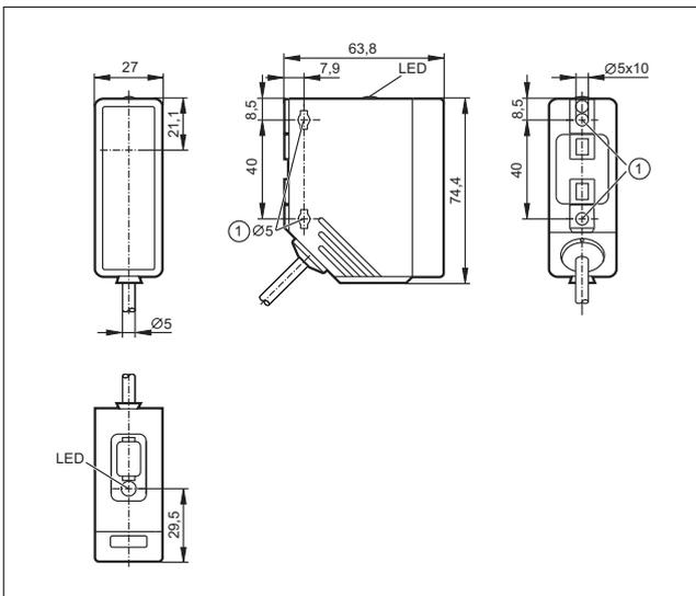
1: Максимальный момент затяжки для крепежного винта М5 - 2 Нм
