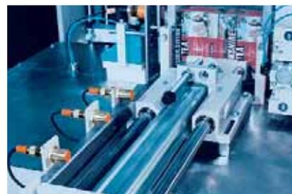
Позиционирование в автоматизированном производстве. Датчики приближения работают без износа.
