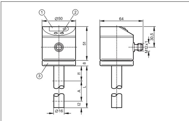
1: 7-сегментный светодиодный дисплей, 2: Кнопки для программирования, 3: Крепление корпуса датчика с помощью клеммы для заземления кабеля с поперечным сечением 1,5...2,5 мм<sup>2</sup>
