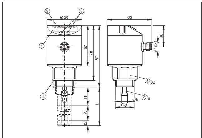
1: 4-х позиционный буквенно -цифровой дисплей, 2: Светодиоды (дисплей / состояние переключения выхода), 3: Кнопки для программирования, 4: Уплотнение, А: Активная область, I1 / I2: Неактивная область
