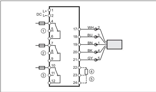
1: Контроль потока, 2: Контроль обрыва провода, 3: Контроль температуры, 4: Время задержки включения питания, 5: Выбор среды: жидкость / газ
