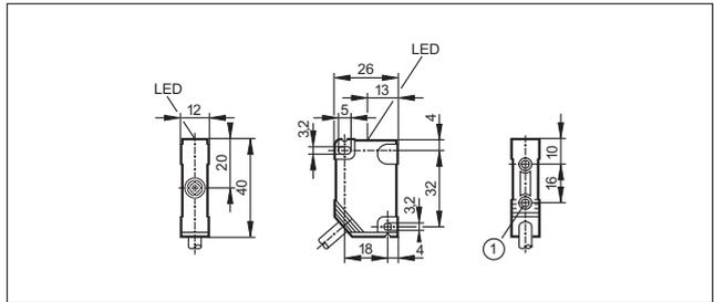
1: Соединительная втулка, резьба М3, глубина 5,8 мм, макс. момент затяжки 1,2 Нм (крепежный винт тип 8.8), если латунная втулка в контакте с ответной частью
