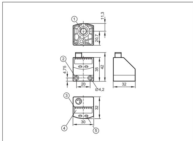
1: Резьбовое соединение с процессом G 1/8; макс. допустимый момент затяжки 8 Нм, Макс.длина резьбы: 7,5 мм, 2: для крепежного винта M4; макс. момент затяжки 2,5 Нм, 3: Светодиоды (дисплей / состояние переключения выхода), 4: 4-х позиционный буквенно-цифровой дисплей, 5: Кнопка для программирования
