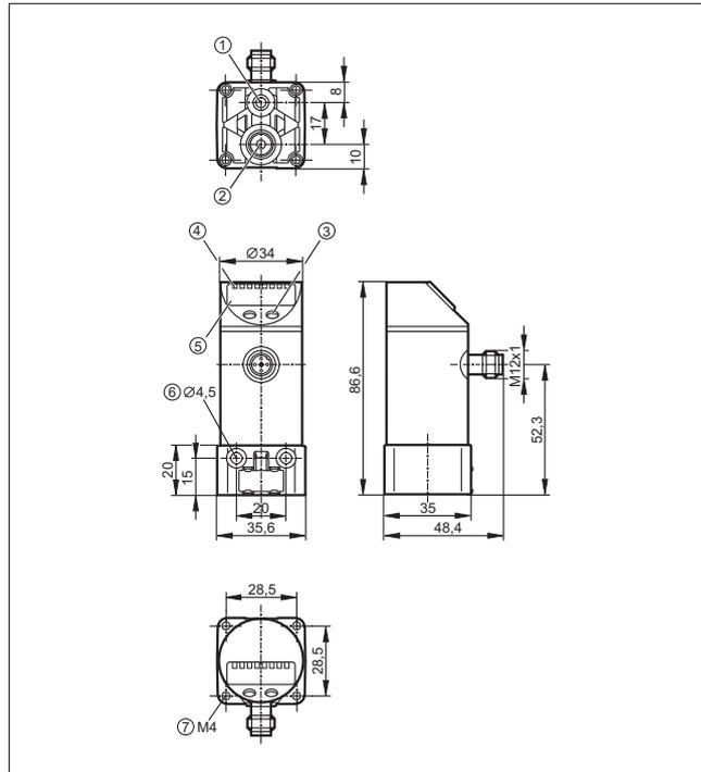
1: Резьбовой разъем для вентиляции M5; макс. момент затяжки 2,5 Нм, 2: Резьбовое соединение с процессом G 1/8; макс. допустимый момент затяжки 8 Нм, 3: Кнопка для программирования, 4: Светодиоды (дисплей / состояние переключения выхода), 5: 4-х позиционный буквенно-цифровой дисплей, 6: для крепежного винта M4; макс. момент затяжки 2,5 Нм, 7: для крепежного винта M4; макс. момент затяжки 2,5 Нм
