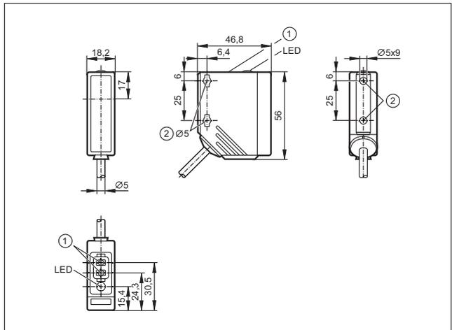
1: Кнопки для программирования, 2: Максимальный момент затяжки для крепежного винта M5 - 2 Нм
