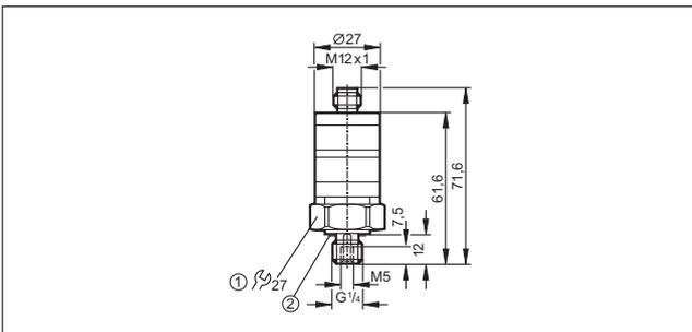
1: момент затяжки 25 Нм, 2: Уплотнение FPM / DIN 3869-14
