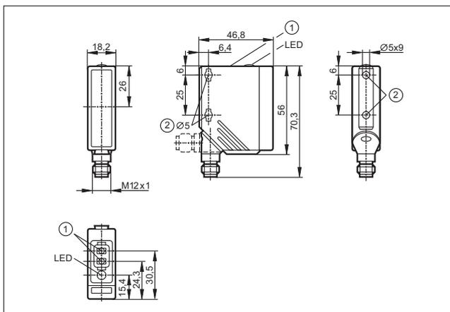
1: Кнопки для программирования, 2: Максимальный момент затяжки для крепежного винта M5 - 2 Нм
