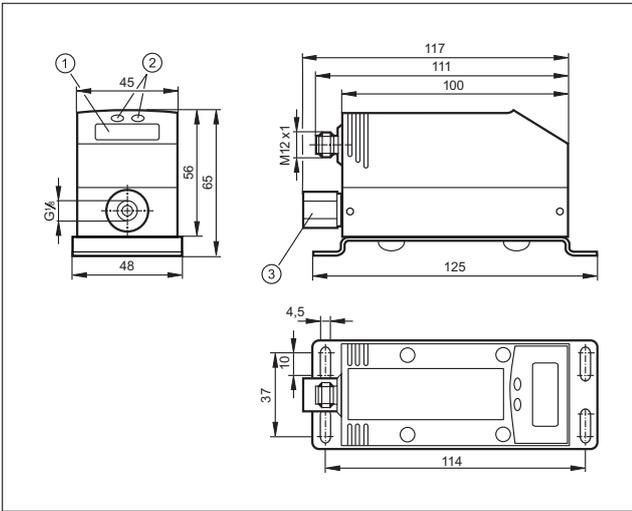
1: 4-х позиционный буквенно-цифровой дисплей, 2: Кнопки для программирования, 3: стабилизатор потока
