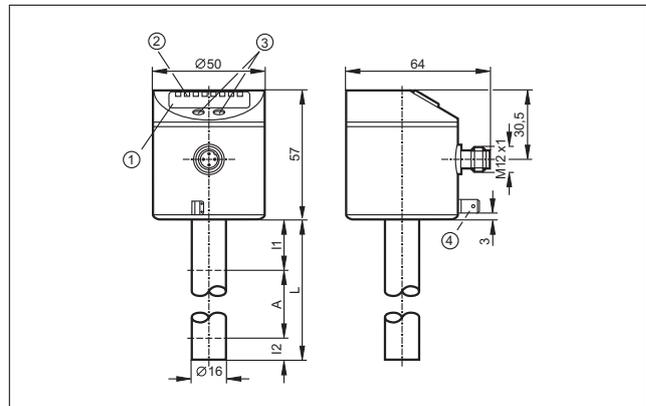
1: 4-х позиционный буквенно-цифровой дисплей, 2: Светодиоды состояния, 3: Кнопки для программирования, 4: Подключение корпуса (разъем с плоскими клеммами 6.3 мм согласно DIN 46244)
