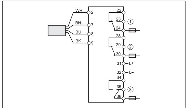
1: Контроль потока, 2: Диагностика неисправности, 3: Контроль температуры, Примечание: миниатюрный предохранитель по стандарту IEC60127-2 лист 1,, ≤ 5 A (быстродействующий), Предохранитель должен находиться за пределами взрывоопасной зоны.
