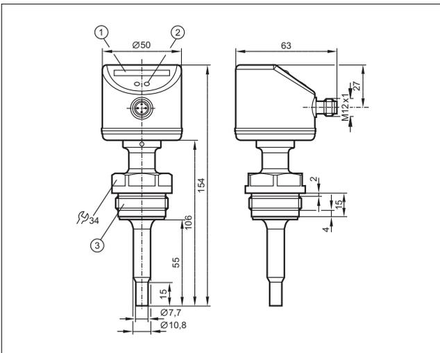
1: Светодиодный дисплей, 2: Кнопка настройки, 3: Резьба G1/Aseptoflex Vario
