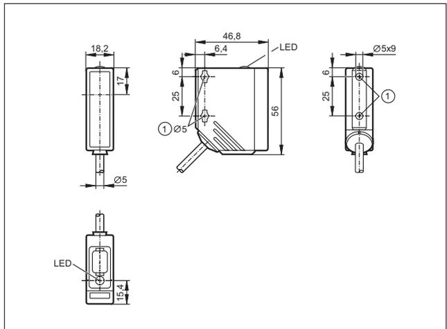
1: Максимальный момент затяжки для крепежного винта M5 - 2 Нм
