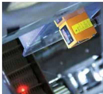
efector pmd генерирует аналоговый сигнал, пропорциональный расстоянию от датчика до объекта.
