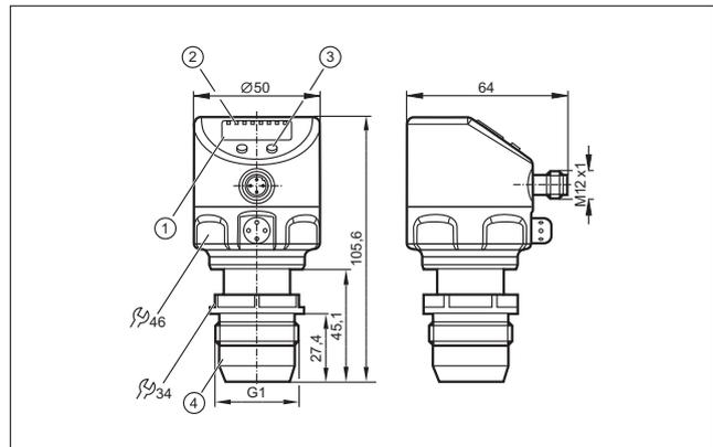
1: 4-х позиционный буквенно -цифровой дисплей, 2: Светодиоды состояния, 3: Кнопка для программирования, 4: Уплотнительный конус G 1 А, Внимание: Прибор должен устанавливаться только в рабочее соединение для уплотнительного конуса G1! Уплотнительный конус G1А подходит только для адаптеров с металлическим концевым ограничителем!
