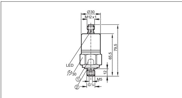
1: Механизм разгрузки давления, Не прибегайте к механической силе на механизм разгрузки давления., 2: Уплотнение FPM / DIN 3869-14
