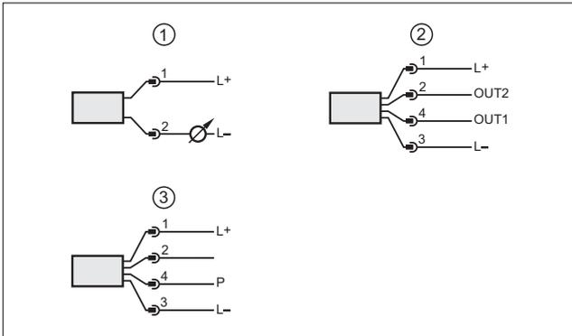
1: 2 - проводная схема подключения, 2: 3 - проводная схема подключения, 3: Подключение для параметризации IO-Link (P = соединение через IO-Link)
