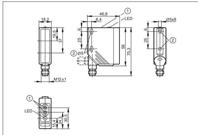
1: Кнопки для программирования, 2: Максимальный момент затяжки для крепежного винта M5 - 2 Нм
