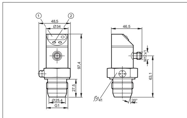
1: 7-сегментный светодиодный дисплей, 2: Кнопка для программирования
