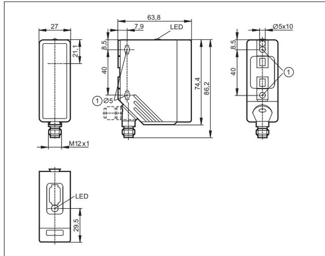
1: Максимальный момент затяжки для крепежного винта М5 - 2 Нм
