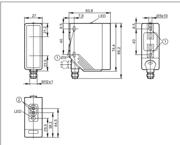
1: Максимальный момент затяжки для крепежного винта М5 - 2 Нм, 2: Кнопки для программирования
