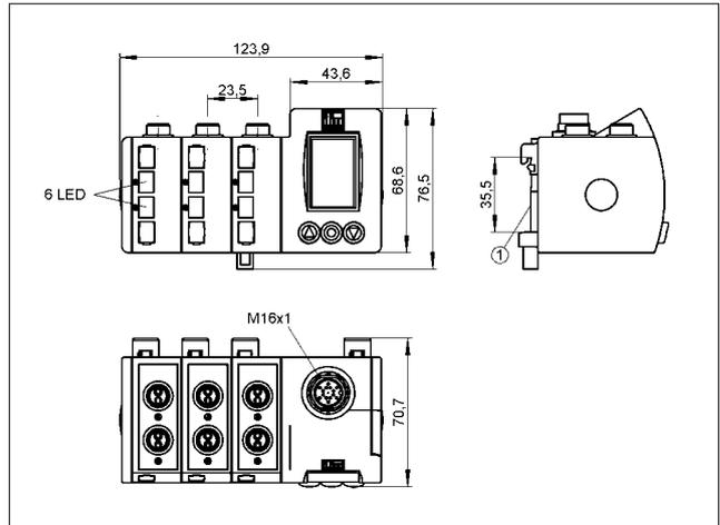
1: Установка на DIN-рейке
