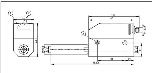
1: 4-х позиционный буквенно -цифровой дисплей, 2: Кнопки для программирования, 3: отверстие для крепежных винтов M5
