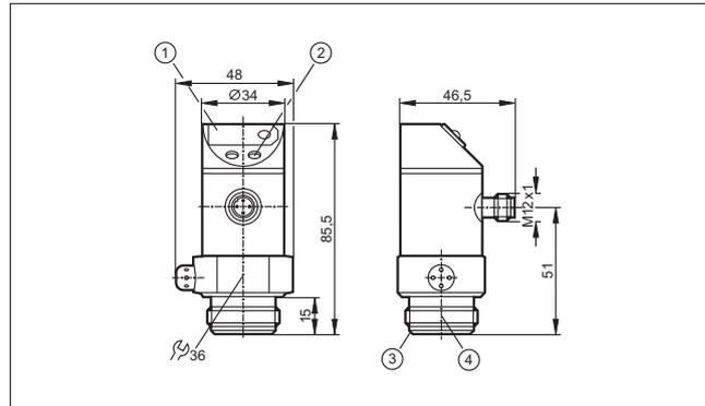
1: 7-сегментный светодиодный дисплей, 2: Кнопка для программирования, 3: Кромка уплотнения Aseptoflex, 4: Резьба ASEPTOFLEX
