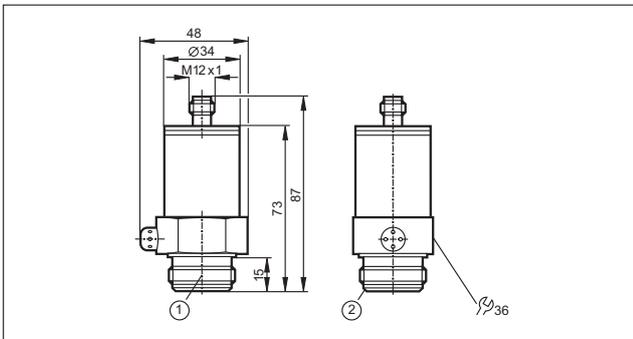
1: Резьба ASEPTOFLEX, 2: Кромка уплотнения Aseptoflex
