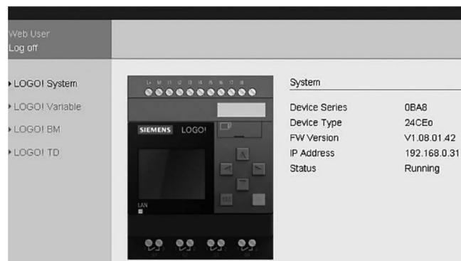
Все логические модули оснащены встроенным web сервером, парольный доступ к которому может выполняться с обычных и планшетных компьютеров Apple iPad, мобильных телефонов Apple iPhone, планшетных компьютеров и мобильных телефонов с операционной системой Android от V2.0.
