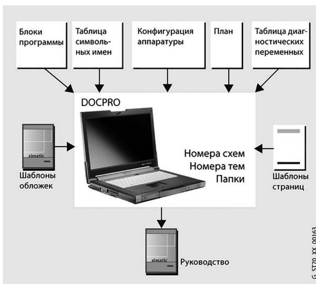
Пакет **DOCPRO** позволяет готовить и обрабатывать заводскую документацию, систематизировать данные проекта, оформлять их в виде связанных описаний и руководств, и распечатывать в виде стандартных форм. Он способен обрабатывать данные всех стандартных инструментальных средств и инструментальных средств проектирования SIMATIC.
