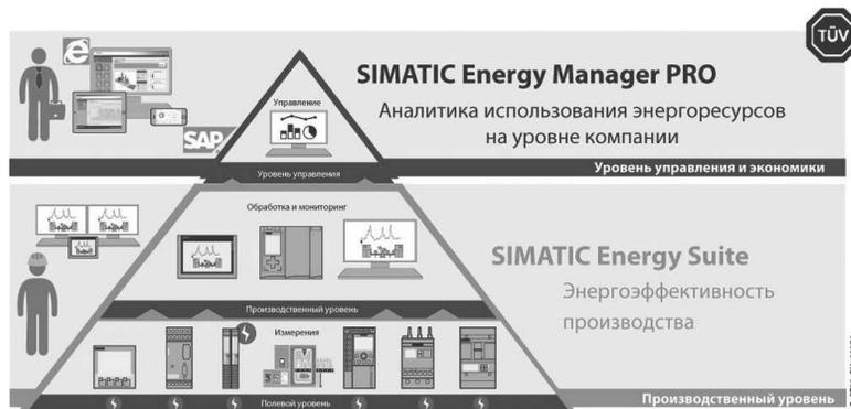
При генерировании энергетической секции программы данные о мощности и энергии отдельных энергетических объектов помещаются в однородные блоки S7, имеющие стандартную структуру. Кроме текущих и периодических значений энергетических показателей эти блоки включают и соответствующие параметры конфигурации.
