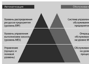
PCS7 Maintenance Station оснащает SIMATIC PCS7 инструментальными средствами, позволяющими снизить общую стоимость затрат на обслуживание предприятия. В системе управления Maintenance Station выполняет функции управления оборудованием предприятия, а также все действия, направленные на диагностику, поддержание и обслуживание средств автоматизации, в том числе интеллектуальных полевых приборов.
