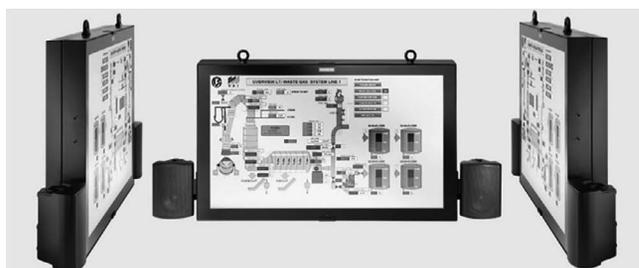
на панелях. Содержимое экранов распределяется между панелями с помощью программного обеспечения WinCC.
